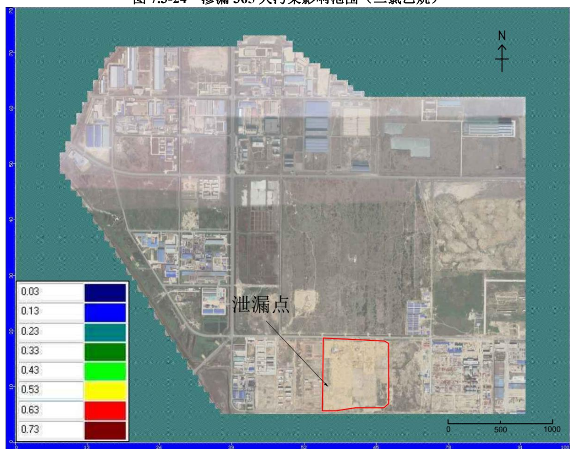
图 7.3-25 渗漏 1000 天污染影响范围（二氯乙烷）
