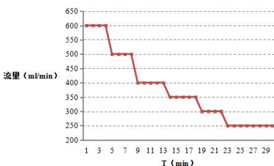
图 7.3-2 SK01 渗水试验 Q-t 曲线图
